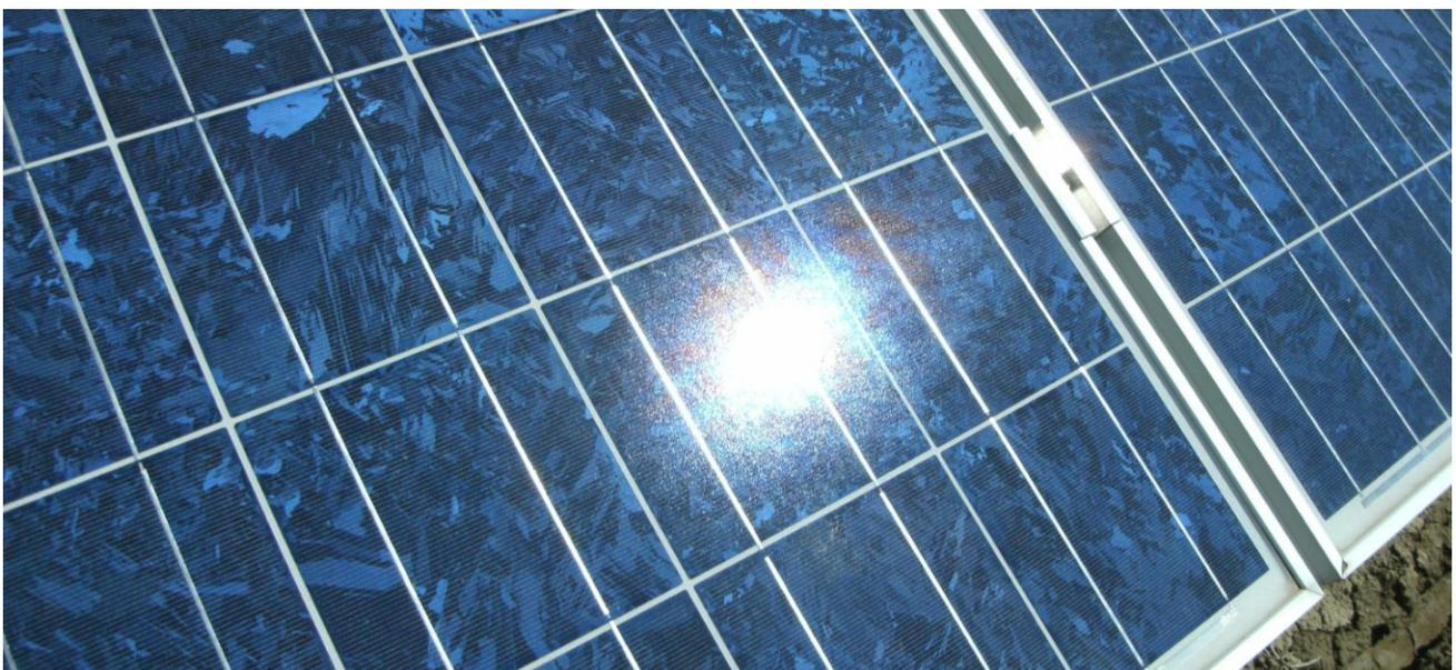
Bild 3.2.2: Diffuse Reflexion von direkten Sonnenlicht (Einstrahlung ca. 980 W/m<sup>2</sup>) auf einem PV Modul (Quelle: SolPEG)
